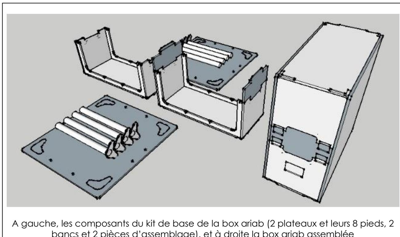
A gauche, les composants du kit de base de la box ariab (2 plateaux et leurs 8 pieds, 2 bancs et 2 pièces d'assemblage), et à droite la box ariab assemblée
